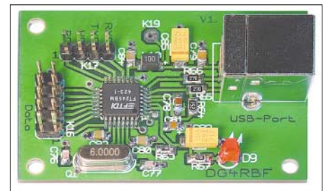
Bild 18: Die USB-Schnittstellenplatine ist nur für die Kopplung mit einem PC erforderlich. Soll der Netzwerkanalysator als reines Stand-alone-Gerät arbeiten, kann sie entfallen.
