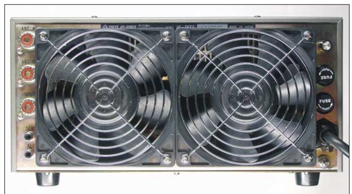
Bild 6: Rückansicht der Linear-Endstufe HL-2KFX. Den meisten Raum nehmen die beiden großzügig dimensionierten Ventilatoren ein. Links bzw. rechts sind die Anschlussbuchsen und Sicherungseinsätze erkennbar.
