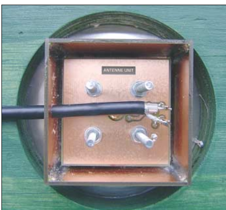
Bild 5: Eine der vier Umschalteneinheiten; der Mittelanschluss der SO239-Buchsen ist jeweils direkt an die Leiterplatte gelötet. Das Abschirmgeflecht des RG58-Koaxialkabels kommt nicht mit Masse in Berührung.
