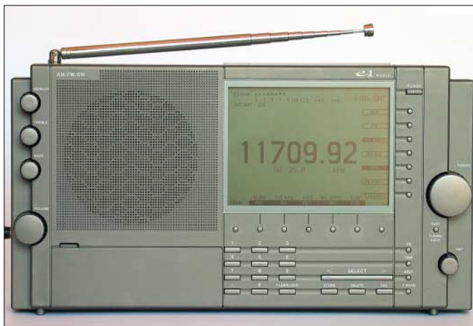
Bild 1: Auf der rechten Hälfte der Gehäusefront umrahmen 35 Tasten und ein Wippschalter das mit einem Format von 116 x 85 mm 2 für einen tragbaren Weltempfänger ungewöhnlich große Punktmatrix-LC-Display mit abschaltbarer Hintergrundbeleuchtung, das sich am besten direkt von vorne ablesen lässt.
