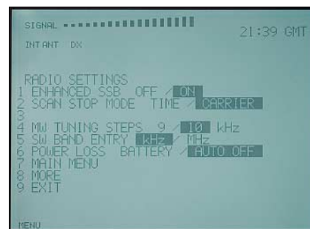
Bild 9: Wichtige Funktionen sind auf der obersten Bedienebene direkt zugänglich. Zu selten geänderten Einstellungen gelangt man übers Menü.
