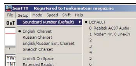
Bild 2: Im Setup-Menü stehen verschiedene Alphabete zur Wahl. Sind mehrere Audiokarten im PC installiert, aktiviert man per Mausklick die für SeaTTY zuständige.
