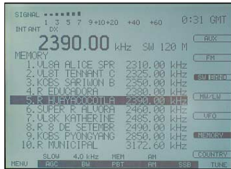
Bild 7: In 500 Speicherplätzen merkt sich der E1 die Empfangsparameter programmierter Stationen.
